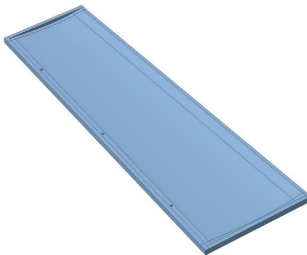
Рис. 6. Макет оснастки для формирования панели и вспомогательных слоев
