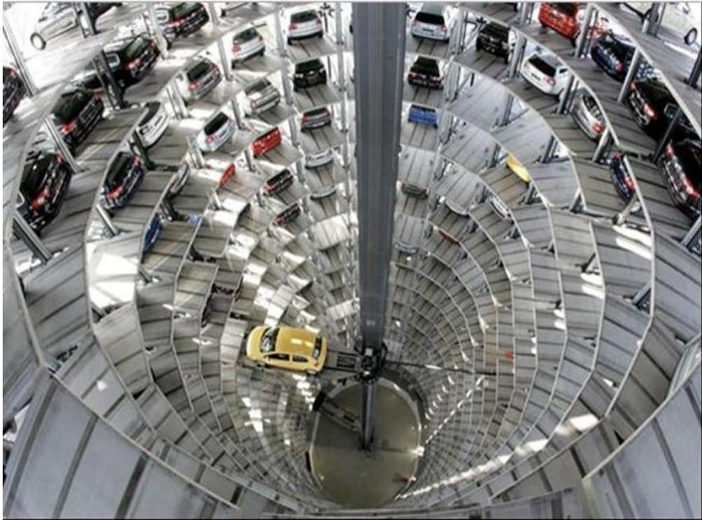
Рис.2. Механизм-приемник в башенной автоматической парковке
