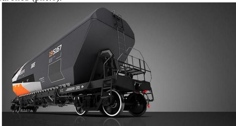
Рис.1. Новый тип грузового железнодорожного вагона из композитных материалов
